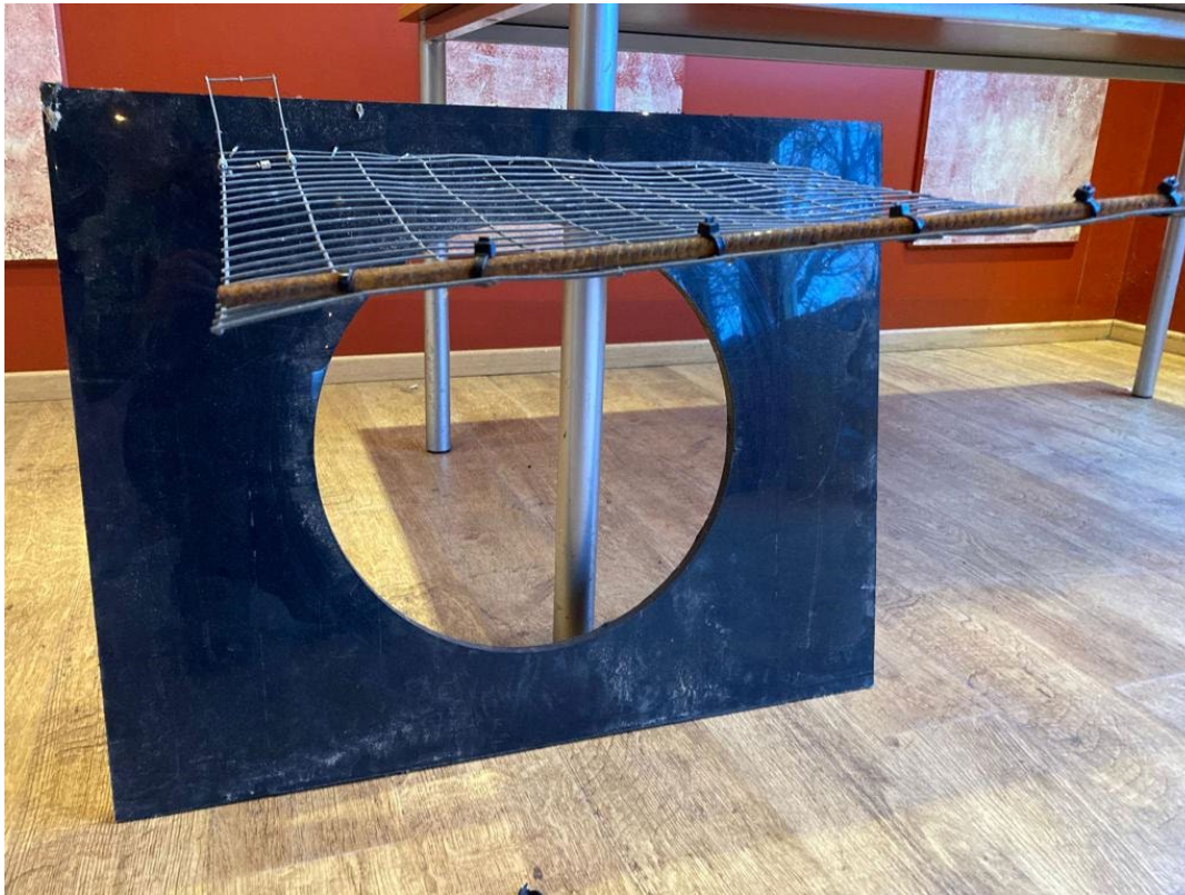
Afbeelding 1: constructie t.b.v. dichtzetten van hol voorzien van terugslagklep (Foto J. van der Baan, Waterschap Hollandse Delta, 2023)
